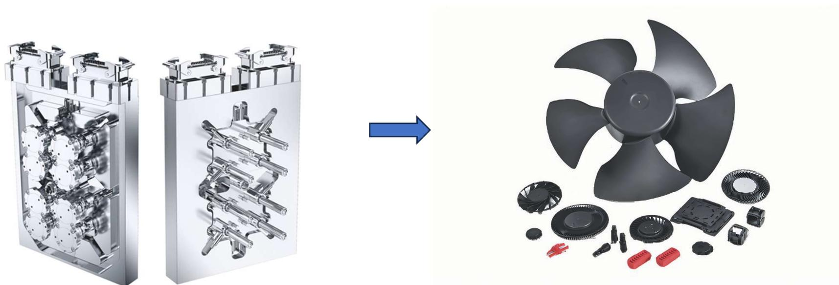
電子部品用システムでは、防火添加剤による腐食や摩耗に耐えるノズルやニードルバルブを採用することにより、耐久性に優れたホットランナーシステムをご提供致します。
