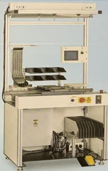
挿入作業テーブル
