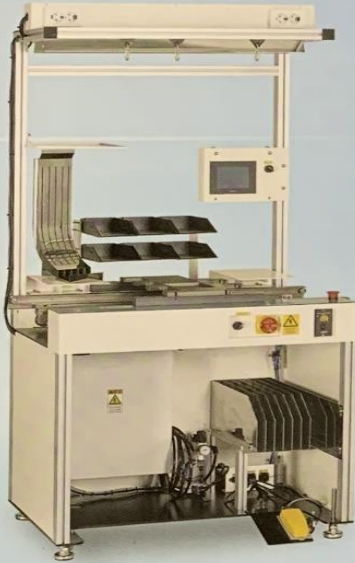
挿入作業テーブル
